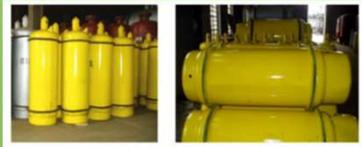
Cilindros para el transporte de cloro
