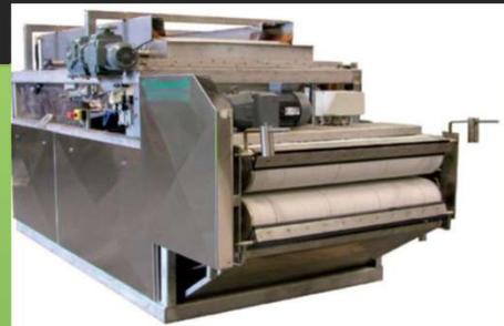
Recogida de lodos en un filtro banda
