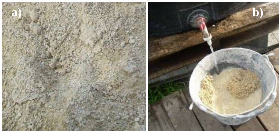
Figura 9. a) Agregado de piedra arcillosa seco. b) Agregado arcilloso con agua, se observa el contenido de arcilla
