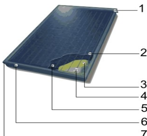
Figura 2. Diagrama del colector solar. Referencias: 1. Boca de salida del bastón de conexionado tipo T; 2. Nylon grueso; 3. Madera compensada (entre 5 mm y 7 mm); 4. Tubos de plastiducto negro 3/4";
