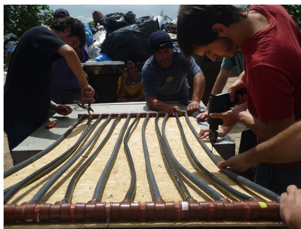
Figura 4. Taller de construcción de colector solar de bajo costo en “Juan Cacharpa”
