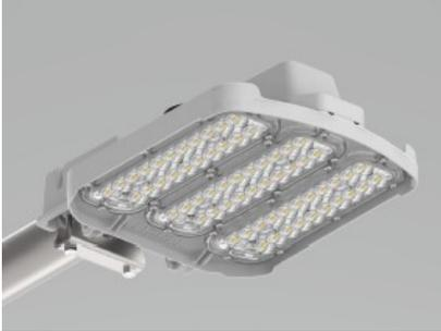
**Artefacto tipo B:** Luminaria tipo proyector con cuerpo de aluminio inyectado y aletas de enfriamiento. Con cavidad para equipo auxiliar separada de la cavidad reflectora. Con unidad generadora de iluminación con tecnología LED, es decir que incorpora luz LED fuente, sistema óptico, disipador de calor y controlador en una carcasa compacta. Potencia 200 Watt. Marca Philips modelo **BVP150 LED170/CW 120-277V 200W**, con las siguientes características técnicas:
