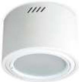
**Artefacto tipo E:** Luminaria de adosar circular, cuerpo y frente, construidos en aluminio, difusor de policarbonato opal y caja de acero estampado esmaltada blanca. Distribución de luz directa y simétrica Tecnología LED. Equipo auxiliar interno. Corrección del factor de potencia por sobre 0,95. Flujo luminoso 38700 Lm, potencia eléctrica 40 Watt, temperatura de color 4000K. Grado de estanqueidad IP44. Marca Lucciola modelo Plafón Kevin ETL540.
