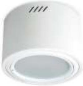
**Artefacto tipo D:** Luminaria de adosar circular, cuerpo y frente, construidos en aluminio, difusor de policarbonato opal y caja de acero estampado esmaltada blanca. Distribución de luz directa y simétrica Tecnología LED. Equipo auxiliar interno. Corrección del factor de potencia por sobre 0,95. Flujo luminoso 650 Lm, potencia eléctrica 7 Watt, temperatura de color 4000K. Grado de estanqueidad IP44. Marca Lucciola modelo Plafón Kevin ETL500.
