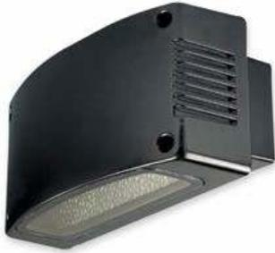
**Artefacto tipo Ba:** Baliza electrónica con iluminación a led y lentes de policarbonato. Cuerpo metálico protegido con pintura epoxi. Intensidad: 35 Candelas. Alimentación: 24Volts C.A. Consumo: 6 Wats. Con comando anexo. Montada sobre los accesorios correspondientes de hierro galvanizado para ser instalada sobre el tanque de agua. Marca EUCA modelo TIM
