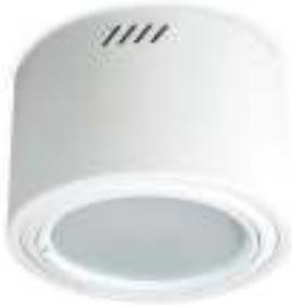
**Artefacto tipo F:** Luminarias polivalentes, para aplicar. Chasis realizado de acero esmaltado, lacado en epoxi-poliéster blanco con terminaciones en ABS. Difusor de policarbonato opalino. Iluminación directa y simétrica. Tecnología Led incorporada 30Watt/ T: 4000 K-Flujo luminoso 3900 Lm. Marca Lucciola modelo Evoluzione Led CXD-030
