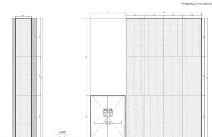
2 - Estas aberturas se materializan con el sistema de frente Integral. El paño superior que se encuentra por encima de la puerta doble, llevará la estructura interna necesaria y el acabado superficial se realizará con idéntica terminación requerida para la puerta que contiene (enchapado en cedro natural).
