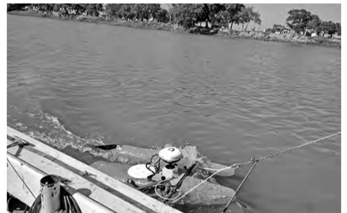
Medición con equipo ADCP (perfilador de corriente acústico Doppler).
