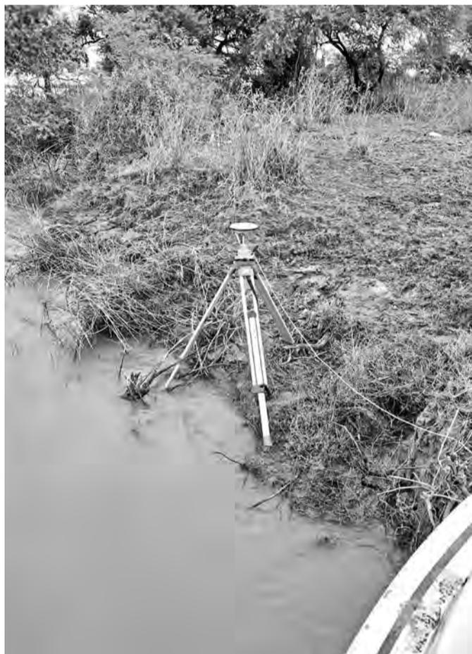
Medición altura de superficie de agua con equipo GNSS.
