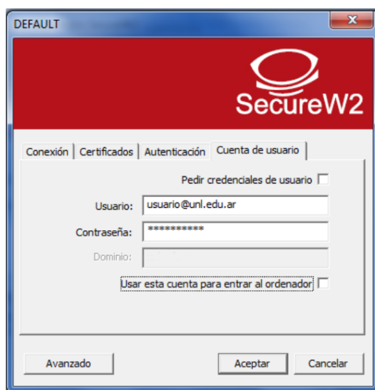
-Figura 16. - Configuración parámetros del protocolo SecureW2: Cuenta de Usuario, acceso por clave CUI -
