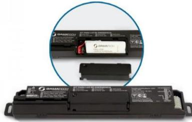
**Artefacto tipo S:** Señalizador autónomo permanente con tecnología led de alta luminosidad. Con pictograma SALIDA con pintura fotoluminiscente. Alimentación 220 Vca. Aislación Clase II. Autonomía mínima 3 horas y tiempo de recarga máximo 12 hs. Apto para montaje sobre superficies inflamables. Tres formas de montaje (cielorraso-lateral-frontal) Con batería de Ni-Cd. Marca Gamasonic modelo Gamatech GX12
