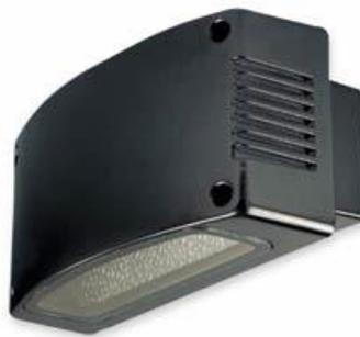
**Artefacto tipo E:** Luminaria de emergencia autonoma no permanente con 90 led. Autonomía a máxima luminosidad 10 hs. Tiempo de recarga 24 hs. Batería de ion litio 3x (3,7 Vcc – 2 Ah). Marca Gamasonic modelo DL20L.
