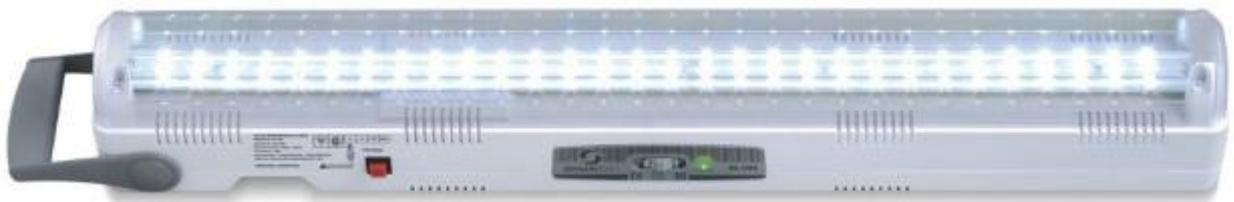
**Artefacto tipo LE:** Unidad electronica de conversión/inversión para convertir un artefacto con tecnología LED en equipo de emergencia autónomo permanente. Apto para lámparas de 6 a 30 Watt. Con batería de Li ion 3.7V 2,2 Ah incorporada. Marca Gamasonic modelo EBM LED.
