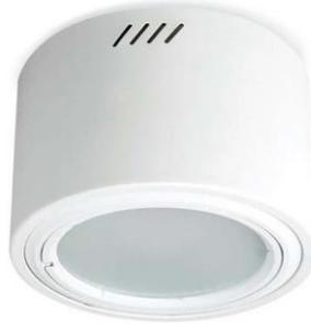
**Artefacto tipo C:** Aplique de pared construido en aluminio inyectado (367x176 mm) -Grado de estanqueidad IP65- Iluminacion simetrica bidireccional con tecnologia LED 2 X 14 Watt. Flujo luminoso de 2x1100 Lm. Marca Lucciola modelo Duplo PR265 LE1. Montaje en forma horizontal.
