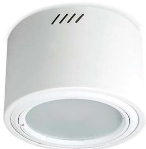
**Artefacto tipo E:** Luminaria de adosar circular, cuerpo y frente, construidos en aluminio, difusor de policarbonato opal y caja de acero estampado esmaltada blanca. Distribución de luz directa y simétrica Tecnología LED. Equipo auxiliar interno. Corrección del factor de potencia por sobre 0,95. Flujo luminoso 38700 Lm, potencia eléctrica 40 Watt, temperatura de color 4000K. Grado de estanqueidad IP44. Marca Lucciola modelo Plafón Kevin ETL540.
