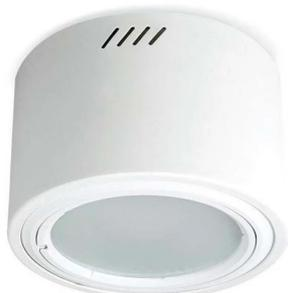
**Artefacto tipo F:** Luminarias polivalentes, para aplicar. Chasis realizado de acero esmaltado, lacado en epoxi-poliéster blanco con terminaciones en ABS. Difusor de policarbonato opalino. Iluminación directa y simétrica. Tecnología Led incorporada 30Watt/ T: 4000 K-Flujo luminoso 3900 Lm. Marca Lucciola modelo Evoluzione Led CXD-030
