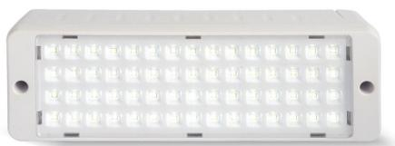
**Artefacto tipo X1:** Unidad de iluminación de emergencia autónoma NO permanente para áreas grandes conformada por dos faros de 5 Watt de tecnología LED de alta luminosidad. Con batería incorporada de Níquel cadmio. Autonomía 3 horas. Marca Gamasonic modelo GX2F 1230NLS.
