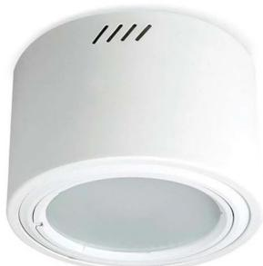
**Artefacto tipo D:** Luminaria de adosar circular, cuerpo y frente, construidos en aluminio, difusor de policarbonato opal y caja de acero estampado esmaltada blanca. Distribución de luz directa y simétrica Tecnología LED. Equipo auxiliar interno. Corrección del factor de potencia por sobre 0,95. Flujo luminoso 650 Lm, potencia eléctrica 7 Watt, temperatura de color 4000K. Grado de estanqueidad IP44. Marca Lucciola modelo Plafón Kevin ETL500.
