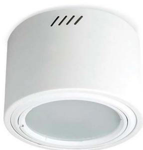
**Artefacto tipo C:** Luminaria de adosar circular, cuerpo y frente, construidos en aluminio, difusor de policarbonato opal y caja de acero estampado esmaltada blanca. Distribución de luz directa y simétrica Tecnología LED. Equipo auxiliar interno. Corrección del factor de potencia por sobre 0,95. Flujo luminoso 2090 Lm, potencia eléctrica 20 Watt, temperatura de color 4000K. Grado de estanqueidad IP44. Marca Lucciola modelo Plafón Kevin ETL502.
