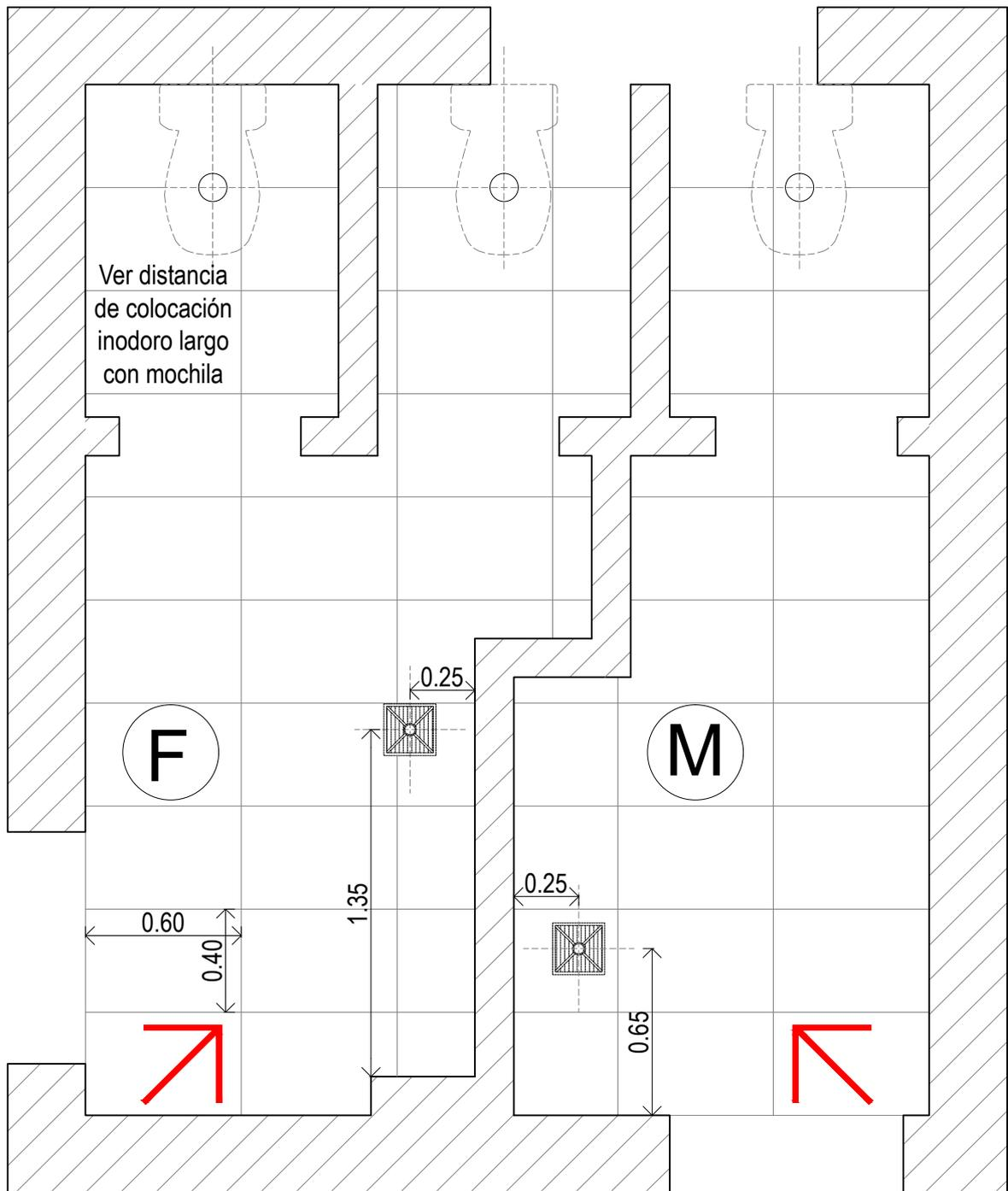
Colocación de pisos tipo marmeta 60x40
